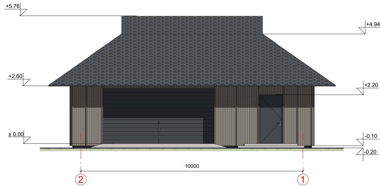
FASADAS TARP AŠIŲ 2-1 M 1:100
