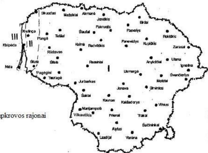
3 pav. Lietuvos vėjo apkrovos rajonai I – v_{ref,0} = 24 m/s, II – v_{ref,0} = 28 m/s, III – v_{ref,0} = 32 m/s (pagal STR 2.05.04:2003) 110 kV KL patenka į III/IV apšalo rajonus.
