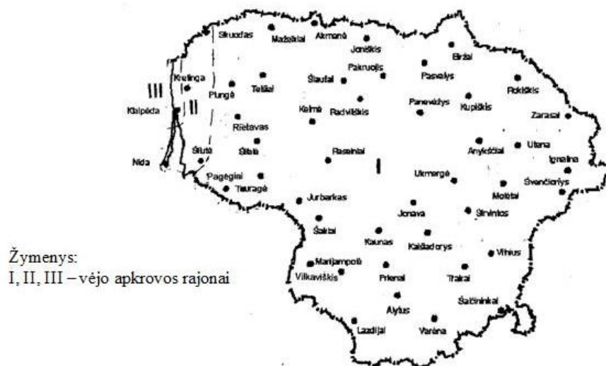
3 pav. Lietuvos vėjo apkrovos rajonai I – v_{ref,0} = 24 m/s, II – v_{ref,0} = 28 m/s, III – v_{ref,0} = 32 m/s (pagal STR 2.05.04:2003)
