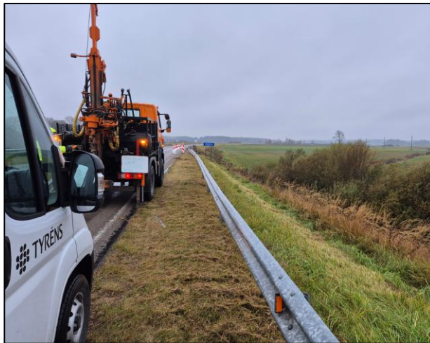
Pav. 1 Gręžimo agregatas H-25SR tyrimų vietose: kairėje Gr.1, dešinėje Gr.4 (aut. T. Mačiulis).
