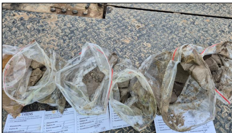
Pav. 2 Gruntų mėginiai iš gręžinio Gr.SZ-3 (aut. T. Mačiulis)
